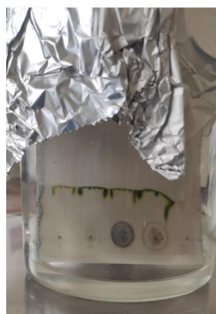
Figura B.17 Sistema de Cromatografía de capa fina con eluyente.
