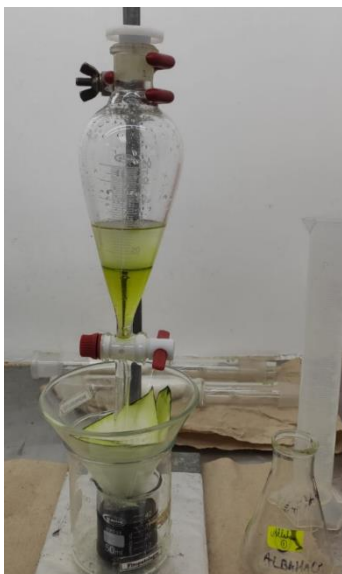
Figura B.10 Extracción Líquido - Líquido de Albahaca.
