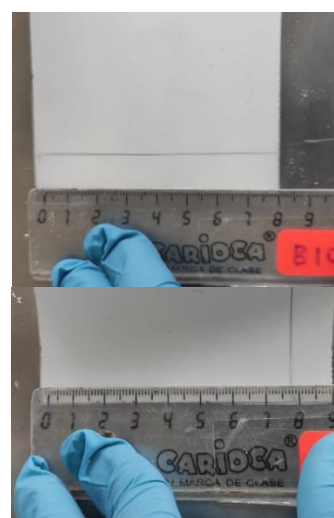
Figura B.15 Medición de las placas cromatográficas.
