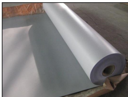
Ilustración 4-18: Piso de vinilo
