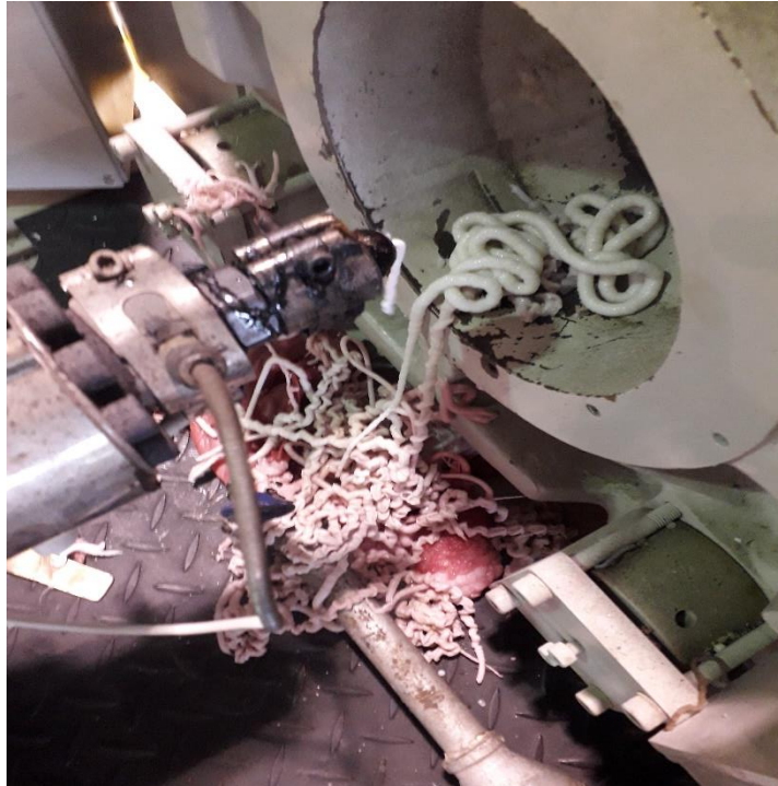
Apéndice Figura 1. Secuencia de proceso de purga por sistema automático
