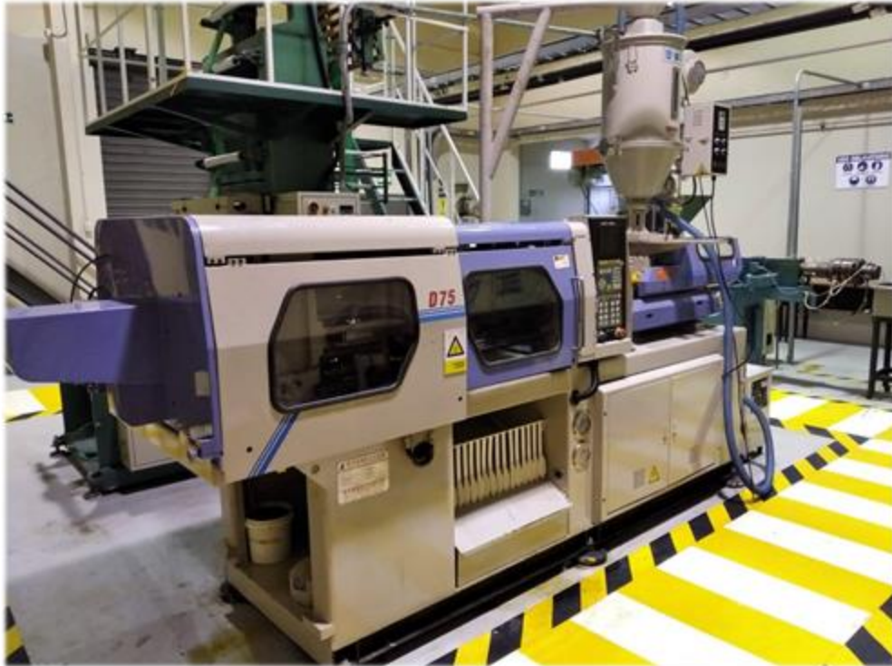
Figura 2.2 Máquina de Inyección, marca Lien Yu, modelo D 75
