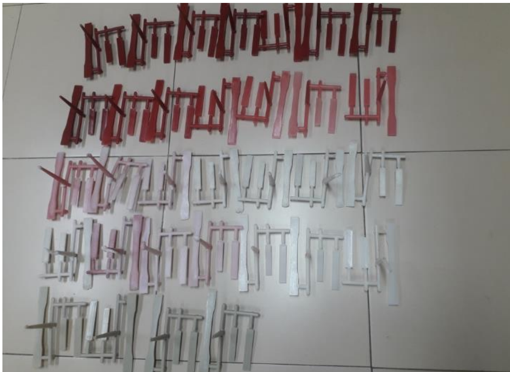
Apéndice Figura 4. Secuencia de proceso de purga por inyección continua a 260°C
