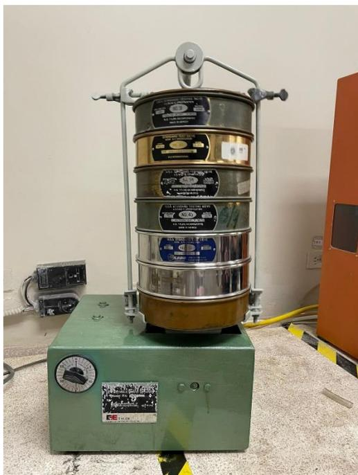
**Ilustración 2.7 Equipo de tamizado
