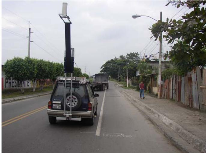
El Scanner Láser mide las fisuras del pavimento en 4 tipos de categoría:
