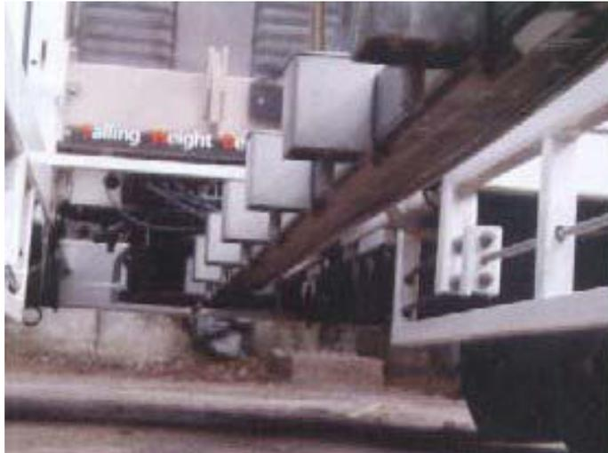
Adicionalmente el equipo registra la temperatura del aire y del pavimento, el kilometraje, y comentarios que el operador puede introducir mediante el computador que controla la operación.
