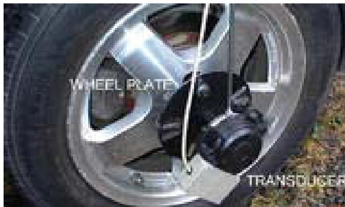
Generalmente los equipos de auscultación tienen integrados odómetros en su estructura (menos los manuales), para poder tener referenciados las medidas obtenidos en ellos.
