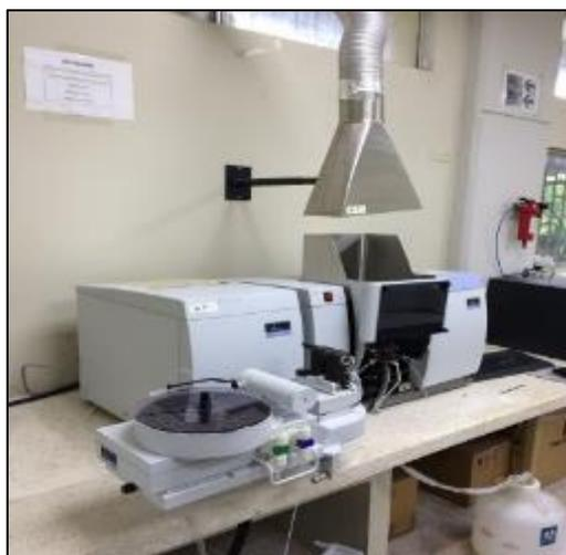
**Figura 2.5: Determinación de metales en espectrofotómetro**
