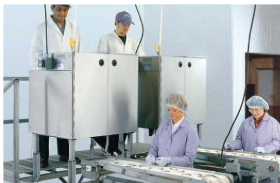
Ilustración 5-26: Máquina Peladora de Camarón Marca Jonsson
