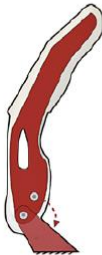
Figura 1.4 Mecanismo de la prótesis Michelangelo [11]
