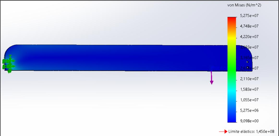
**Figura 3.3 Esfuerzos de Von Mises – soporte del eje X**
