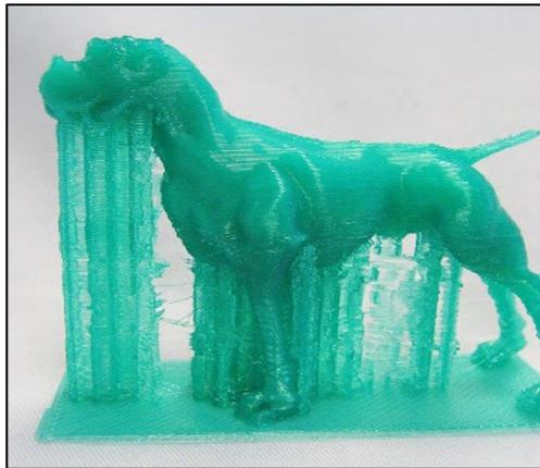
**Figura 1.1 Impresión 3D con soportes**
