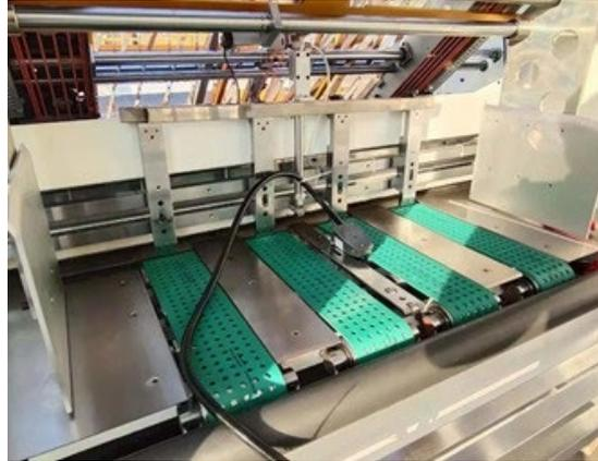
**Figura 1.11 Alimentador inferior por correas de fricción perforadas con succión [8]**
