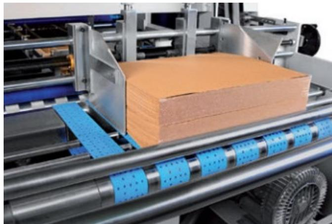
**Figura 1.12 Sistema de placas cuadrador de láminas inferior [6]**
