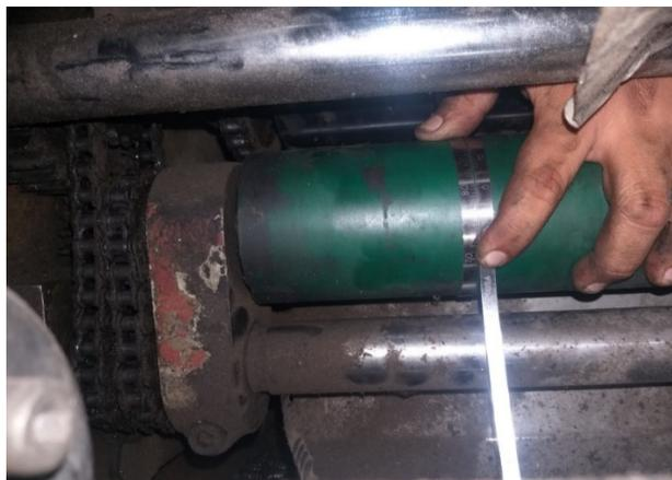
**Figura 2.3 Medición de rodillos con la cinta Pi**
