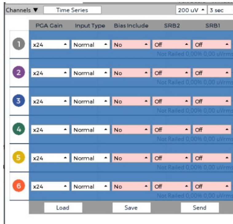
Figura D.2 Configuración de los canales en el widget Time Series del Software OpenBCI GUI [9].
