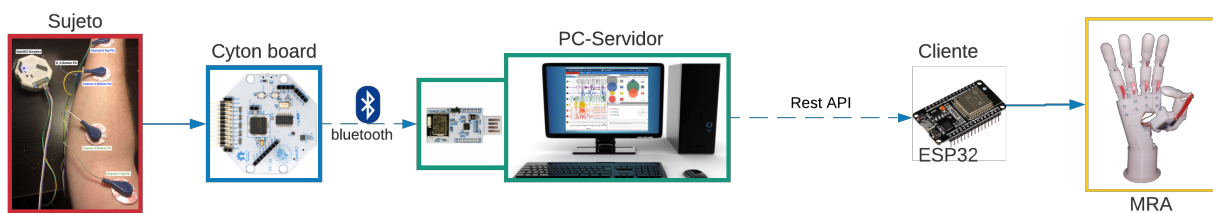
Figura 2.5 Diseño de implementación de la solución B.
