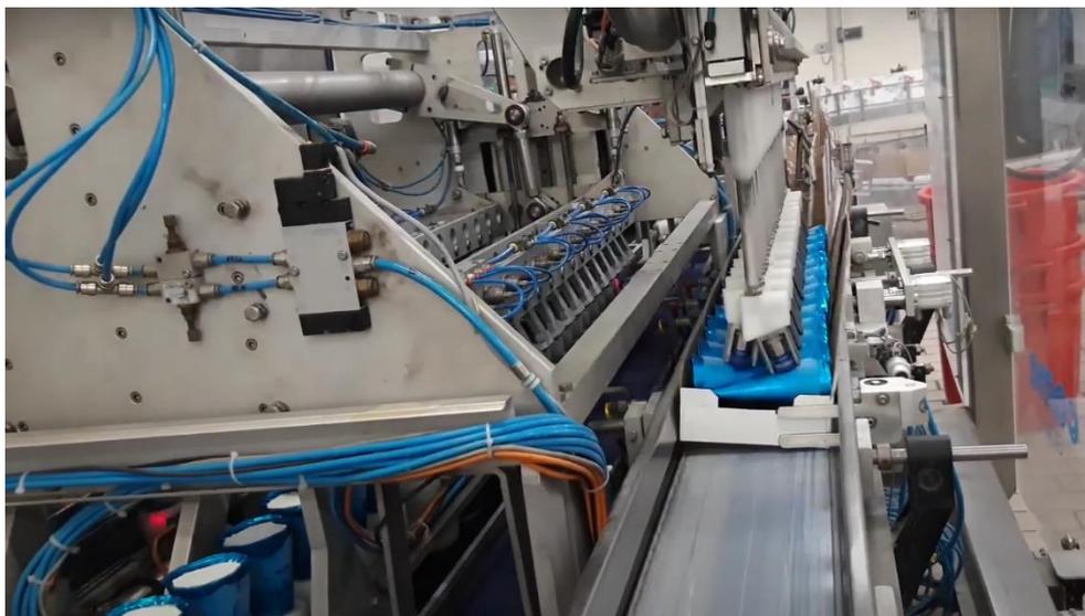
**Figura 1.5. Big Drum Engineering – final de línea con ventosas [13]**
