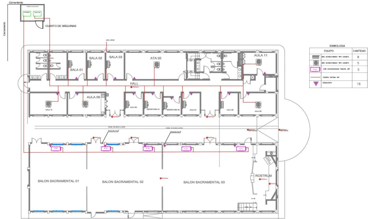
Figura 2.3 Plano de la Iglesia para el análisis y diseño del sistema de climatización [Elaboración propia].
