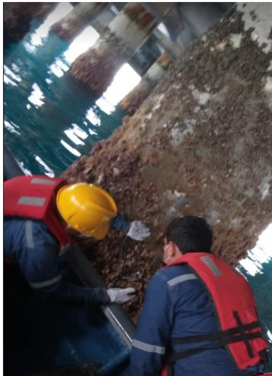
Figura 2.2 Medición de potencial en uno de los pilotes del muelle estudiado [Elaboración propia]
