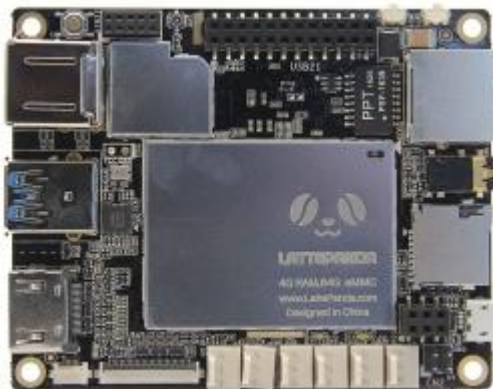
Figura 1.3: Vista superior de la tarjeta LattePanda[28].
