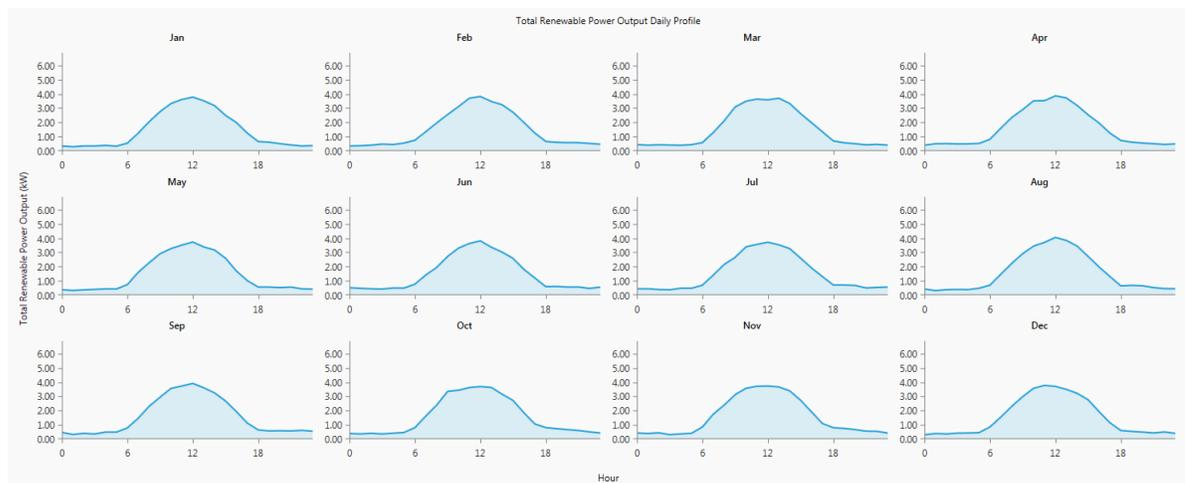
Figura 42. Perfil diario de salida de potencia de los generadores
