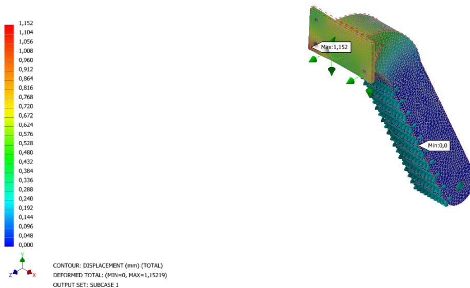
**Figura 3.3 Desplazamiento del Pescante.**
