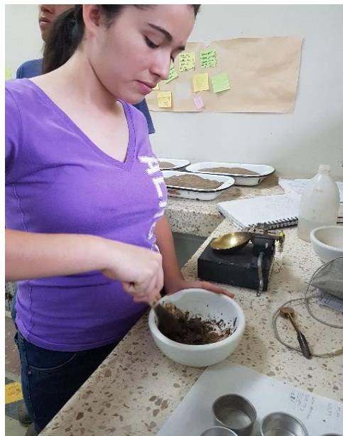
Figura 3. 3 Homogeneización de la muestra. Fuente: Flores, C., Pazmiño, D., 2018.
