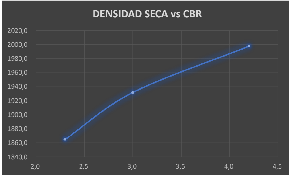
Gráfico B- 14. Curva densidad seca vs CBR calle 5 de Diciembre.
