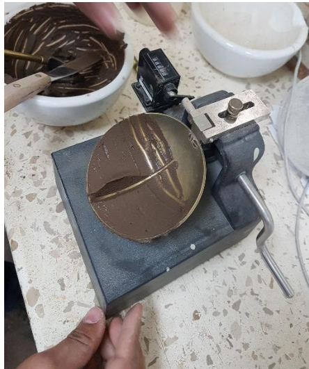
Figura 3. 4 Abertura para la realización de los golpes. Fuente: Flores, C., Pazmiño, D., 2018.
