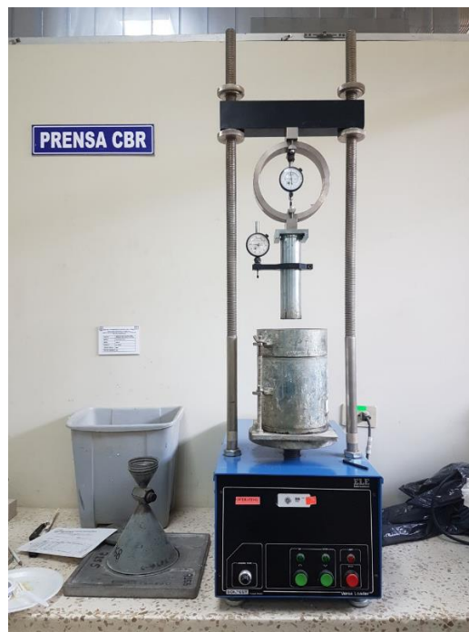
Figura 3. 6 Aparato medidor de expansión. Fuente: Flores, C., Pazmiño, D., 2018
