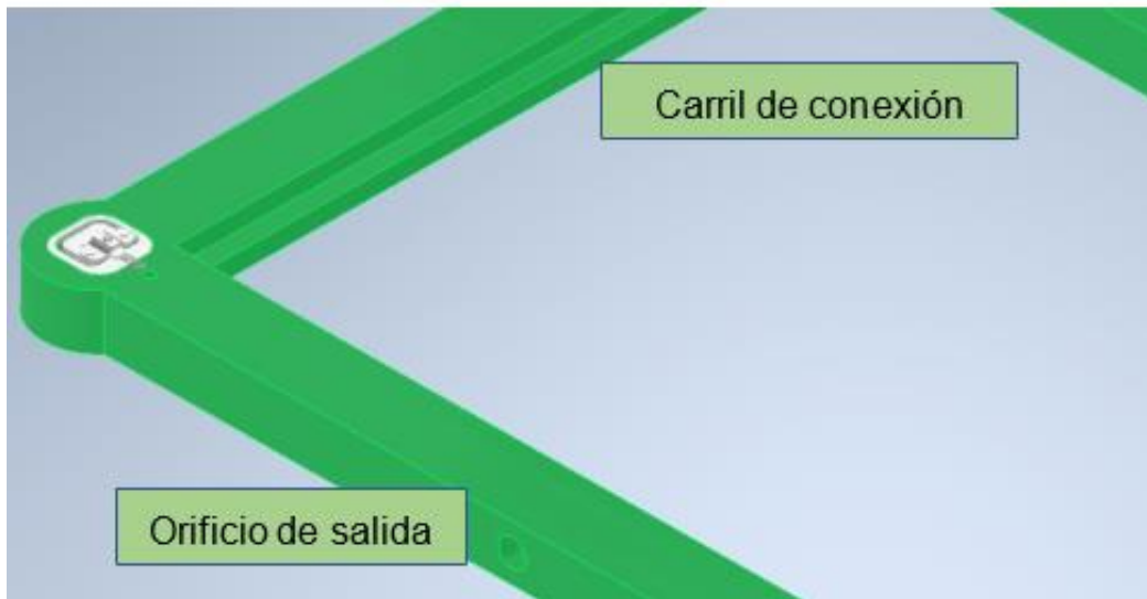
Figura 2.12 Ruta para el paso de cables
