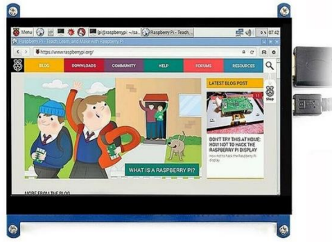
Figura 2.7 Pantalla capacitiva vista frontal [29]
