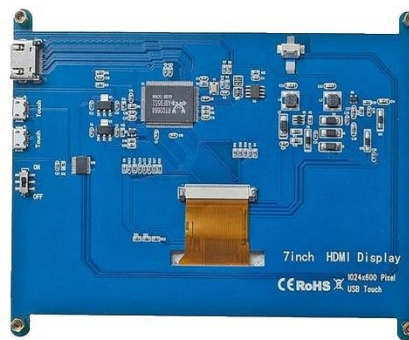
Figura 2.8 Pantalla capacitiva Vista trasera [29]
