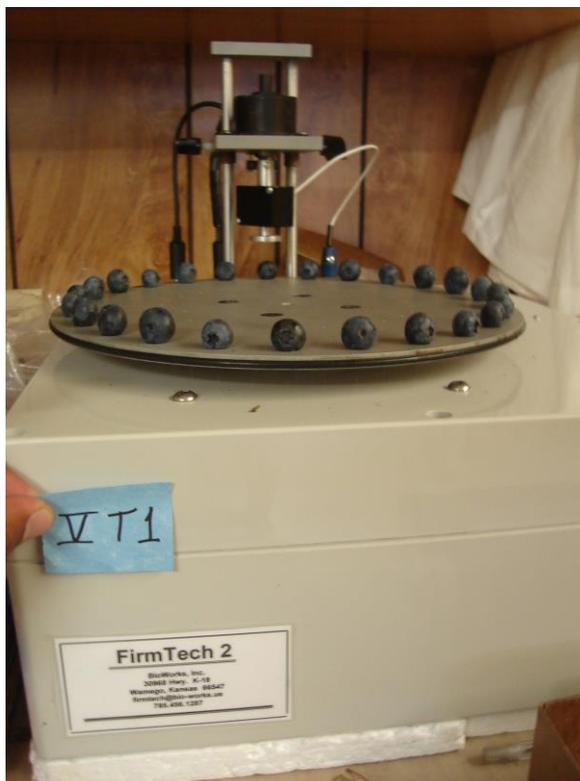
**FIGURA 2.7. MEDICION DE LA FIRMEZA CON LA MAQUINA
