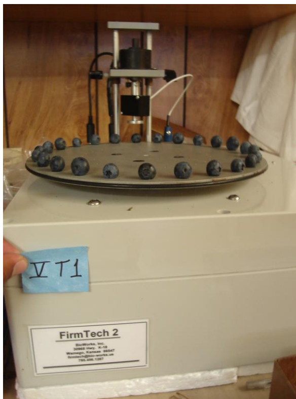
FIGURA 2.7. MEDICION DE LA FIRMEZA CON LA MAQUINA FIRMTECH2
