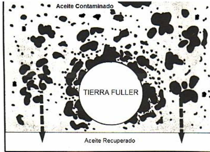
Figura 2.6 Fenómeno de adsorción de Tierra Füller Fuente: Endelstein,J.(2010)
