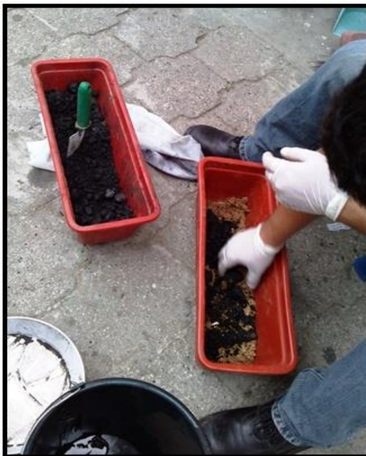
Figura 4.4 Mezclado de tierra contaminada con aserrín
