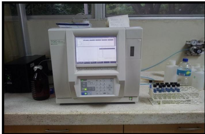
**Figura 3.4** Equipo de medición de carbono orgánico total (TOC), Laboratorio de Aguas, DCQA-ESPOL
