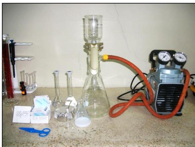
Figura 3.2 Equipo de filtración para realizar los estudios de adsorción por FT-IR, Laboratorio de Espectrometría, DCQA – ESPOL.
