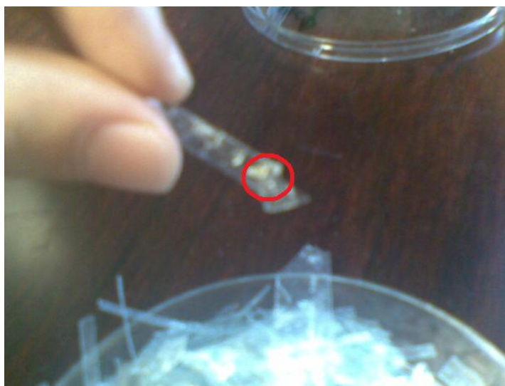
Figura 4.4.b.- PVCT recuperado. En el círculo rojo se resalta una traza de aluminio sin disolver, detectada visualmente.
