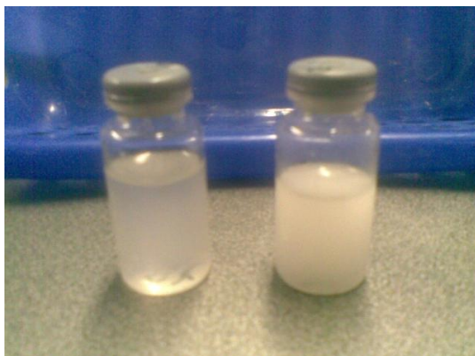
Figura 4.10.- Ensayo para la presencia de cloruros. A la derecha se presenta la solución patrón de HCl. La solución problema, a la izquierda, presenta opalescencia pero es más clara que la patrón.
