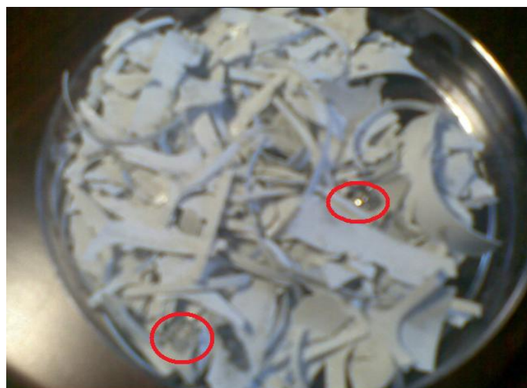
Figura 4.5.b.- PVCB recuperado. Se resaltó con círculos rojos las trazas de aluminio sin disolver que fueron detectadas visualmente.
