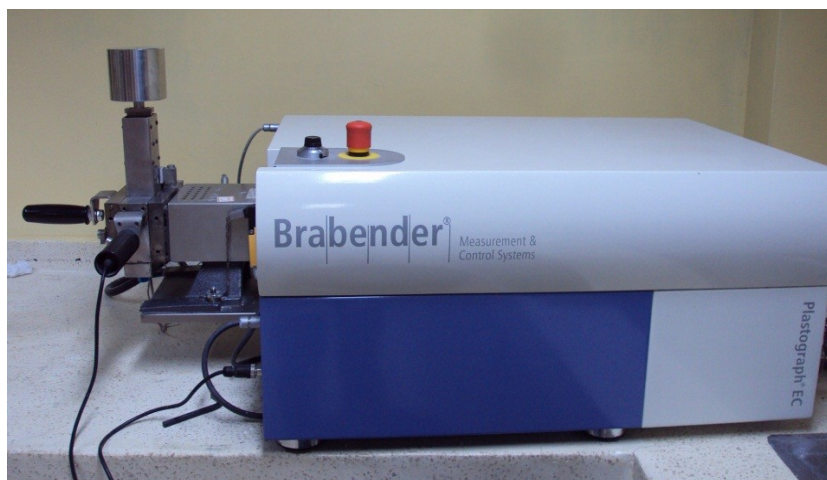
FIGURA 3.17. EQUIPO REÓMETRO DE TORSIÓN BRABENDER, LABORATORIO ASEPLAS, ESPOL.
