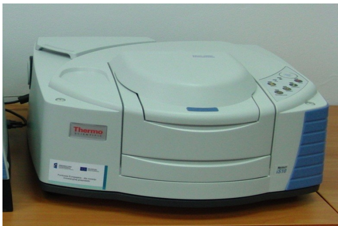
FIGURA 3.16. EQUIPO DE ESPECTROMETRÍA INFRAROJO, ESPECTROMETRÍA, LABORATORIO ICQA, ESPOL.
