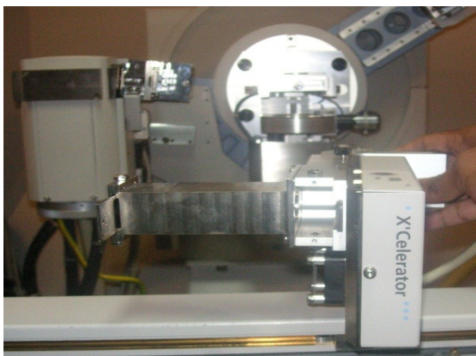
FIGURA 3.14. EQUIPO DIFRACTÓMETRO DE RAYOS X, ACCESORIO X'CELERATOR LABORATORIO CIDNA, ESPOL
