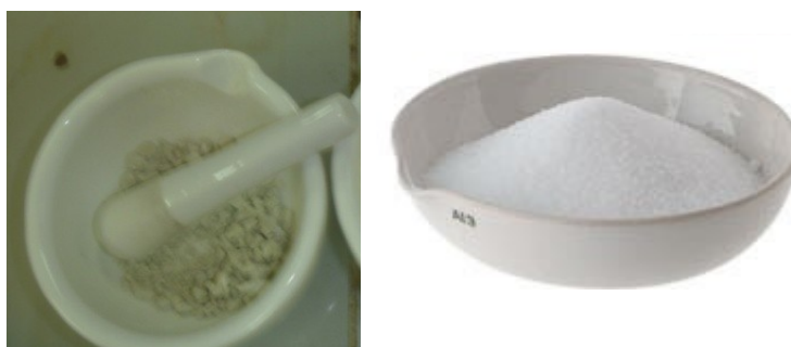
FIGURA 3.21. MOLIENDA DE LA CLOISITE 20A SECA
