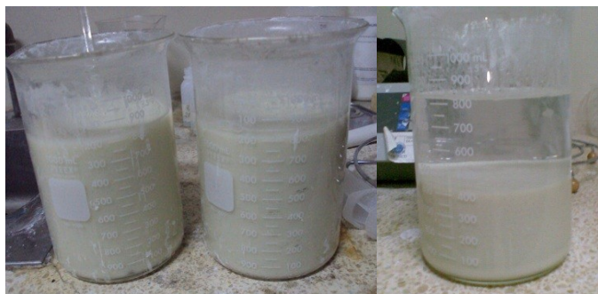
FIGURA 3.19. DECANTACION DE LA CLOISITE 20A
