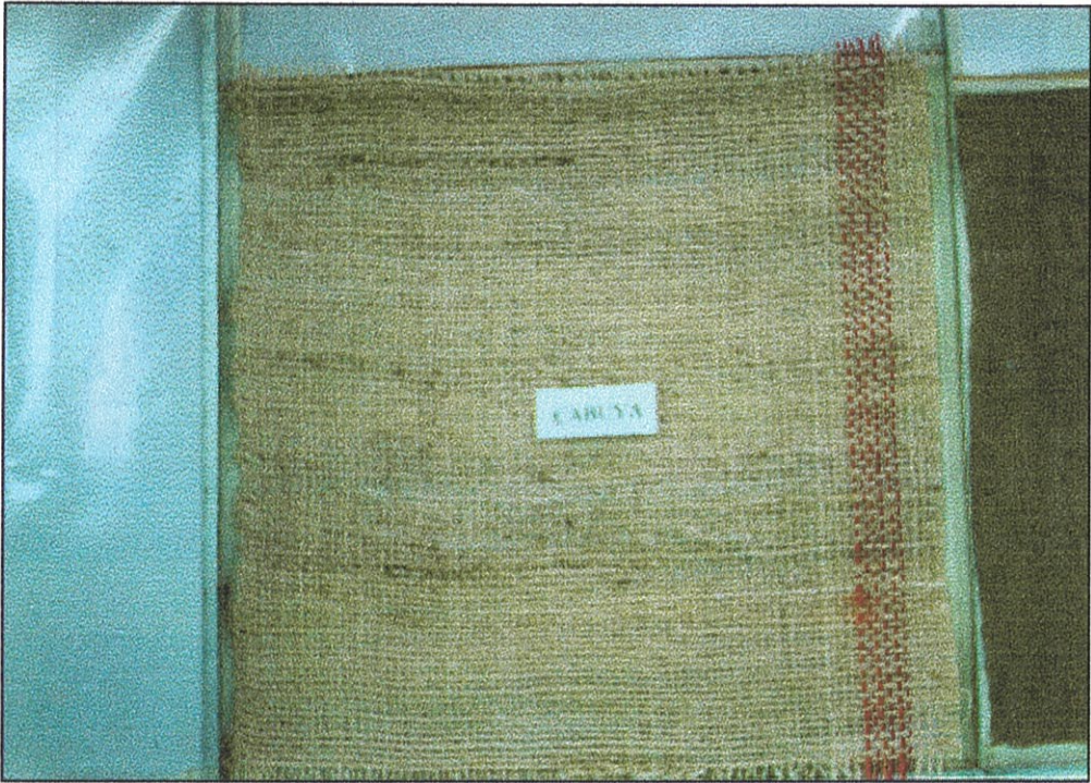
Foto 9 Plancha de material compuesto Cabuya - Resina
