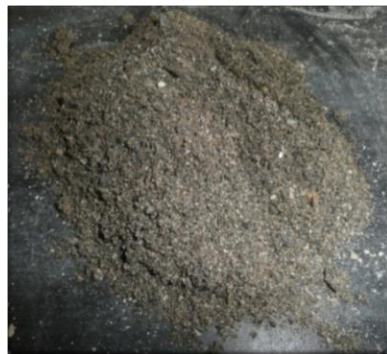
a) Arena a) Arena natural de río
