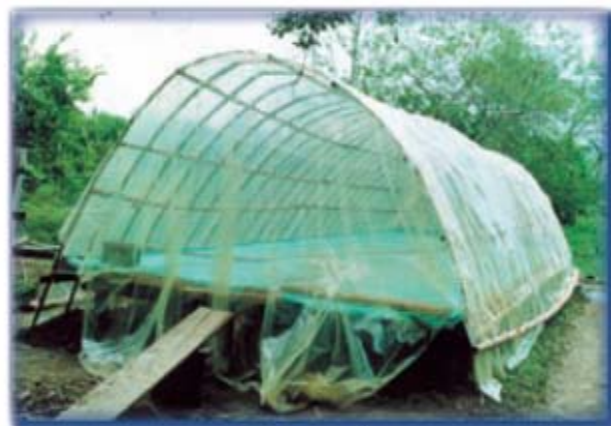
Secador tipo túnel
