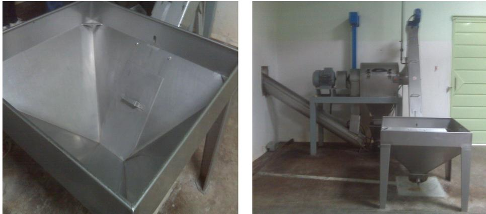
Esta máquina receptorá la masa de aguacate, donde será extraído el aceite, luego pasará a otra similar para su respectiva refinación; culminando este proceso el aceite será transportado por unas tuberías que conllevan el líquido hacia unos tanques de metal inoxidable para luego pasar al embotellado, sellado y etiquetado.
