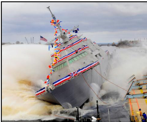
Figura 1. 5. Varada de Carrera Transversal
