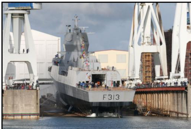
Figura 1. 4. Varada de Carrera Longitudinal
