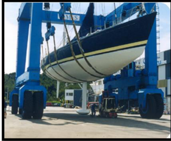
Figura 1.10. Varamiento con Grúas de Pórtico
