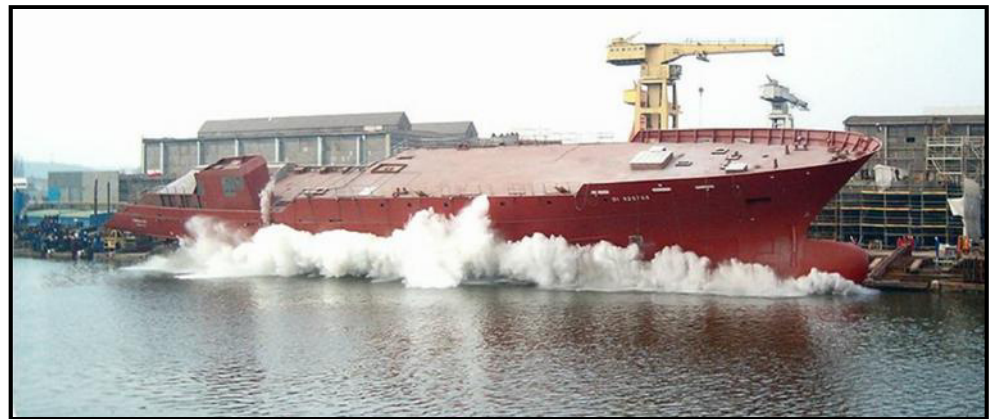
Figura 1. 8. Botadura de Carrera Transversal
