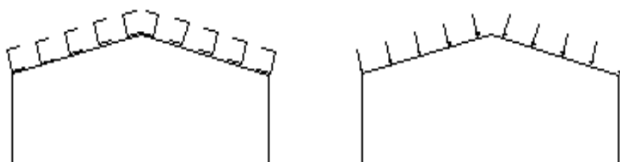
FIGURA 1.6. CONDICIÓN DE CARGA DEBIDA A LOS LARGUEROS
