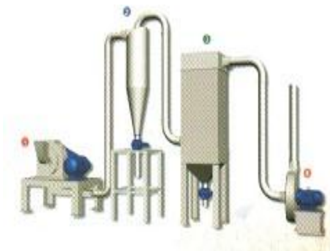
FIGURA 3.7 ESQUEMA DE SISTEMA DESEMPOLVADO
