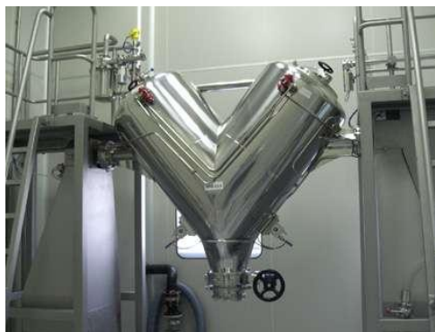
FIGURA 2.4 MEZCLADOR EN V
