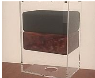
Figura 1.5 Filtración química con carbón activado.
