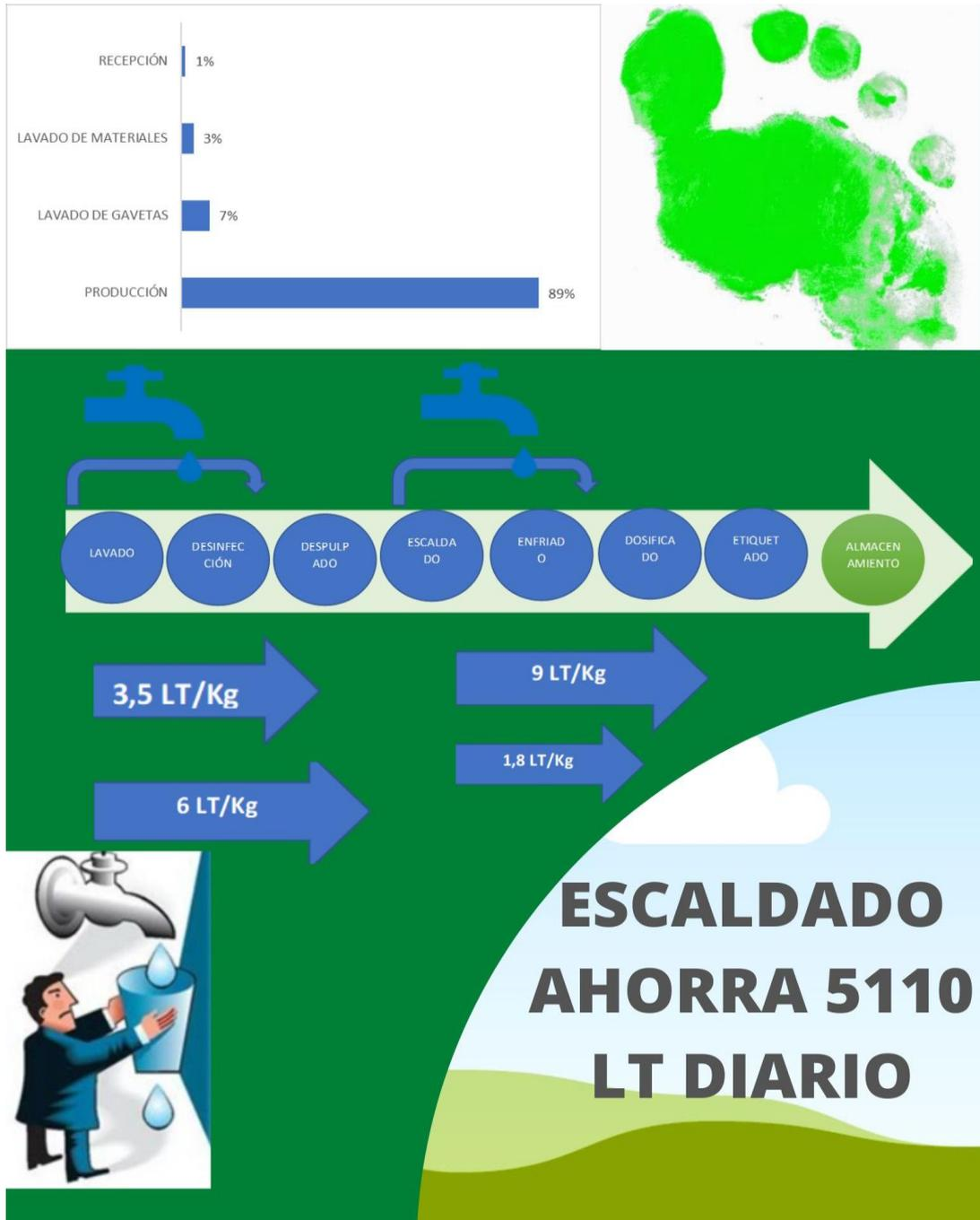
Ilustración 31: Lavado de gavetas mediante el escaldado
