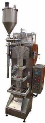
Ilustración 18: Máquina enfundadora de Pulpas
