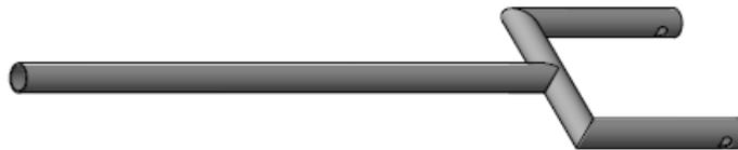
**Figura 2-15** Diseño inicial de la conexión manubrio y rueda
