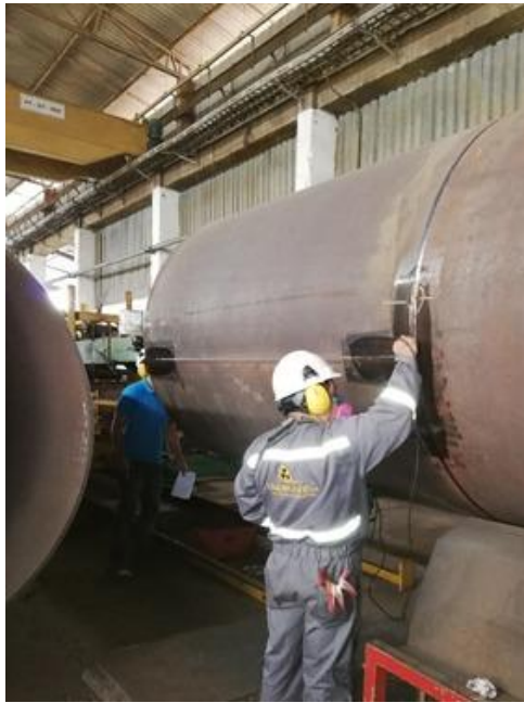
Figura 1.6 Inspección por ultrasonido de soldaduras [Elaboración propia]
