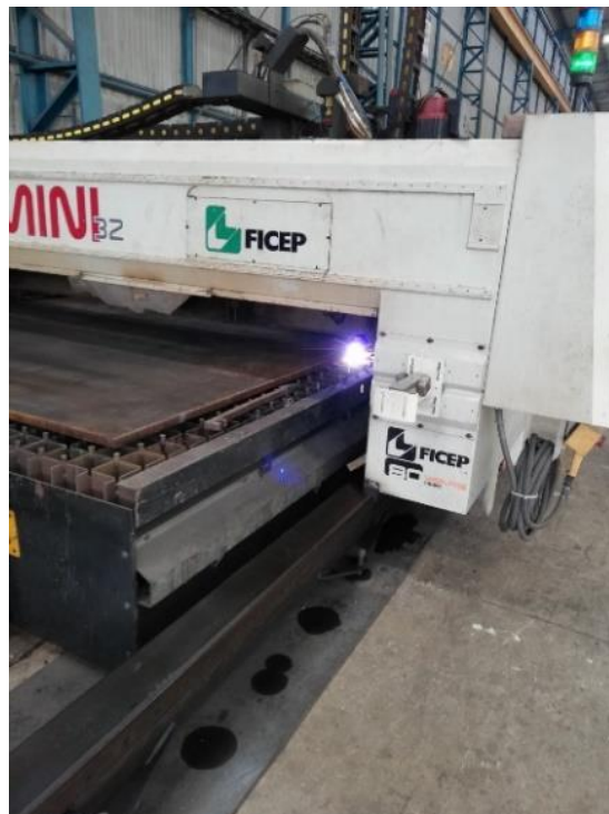
Figura 1.1 Proceso de corte de plancha de acero [Elaboración propia]
