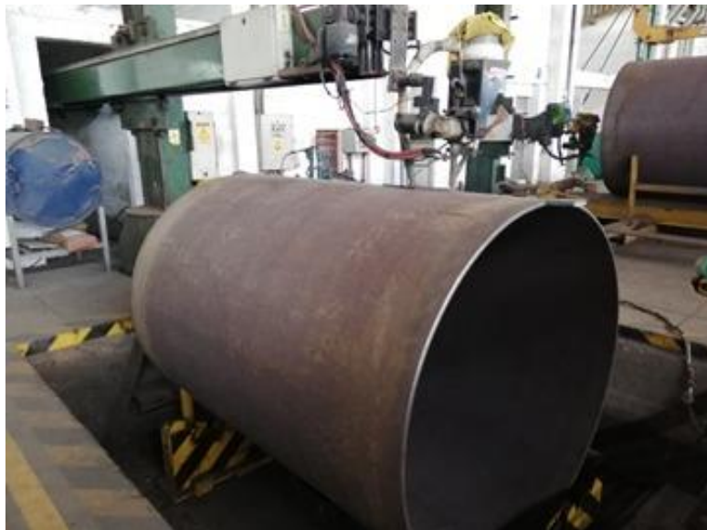
Figura 1.3 Soldadura longitudinal de virolas por arco sumergido [Elaboración propia]
