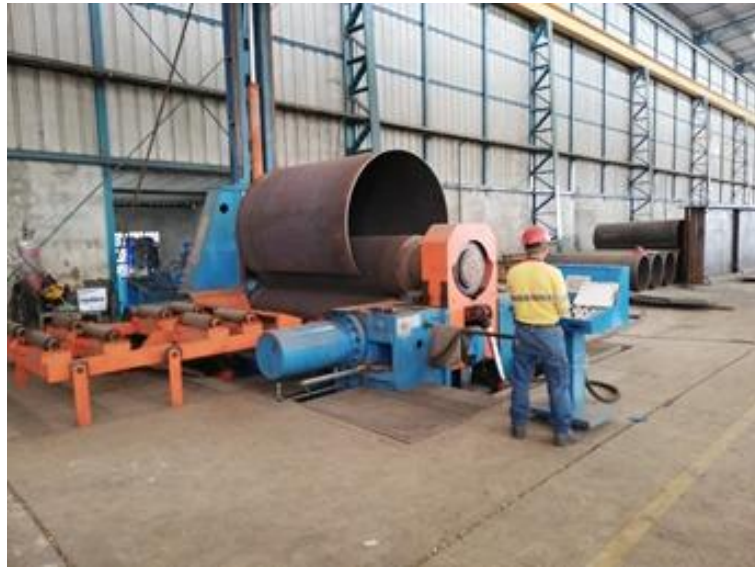
Figura 1.2 Rolado de plancha para formar una virola [Elaboración propia]
