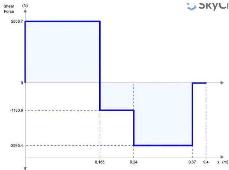
Figura 3.14 Diagrama de Fuerza Cortante del eje en el plano XZ - Análisis dinámico.
