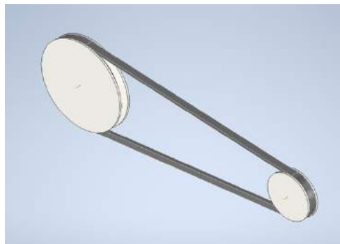
Figura 2.11 Sistema de bandas y poleas.
