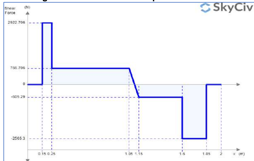
Figura 3.18 Diagrama de fuerza cortante para estructura de la máquina.
