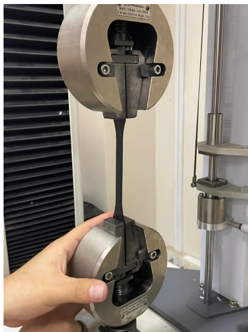
Imagen 3.1 Probeta maciza montada en la máquina de ensayos
