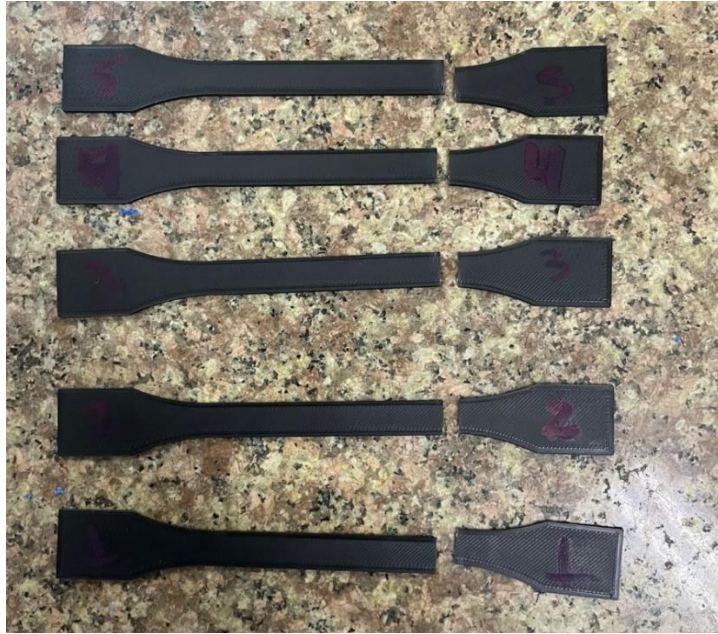
Imagen 3.13 Probetas macizas de ensayos a tracción rotas
