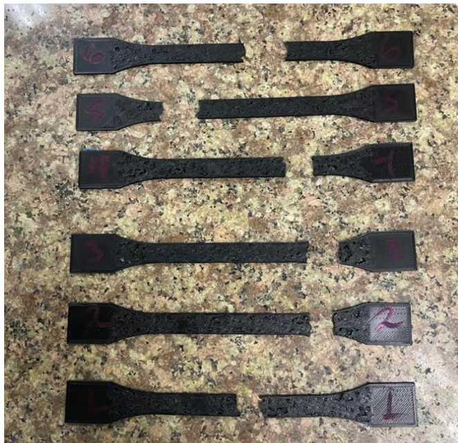
Imagen 3.12 Probetas trabeculares de ensayos a tracción rotas
