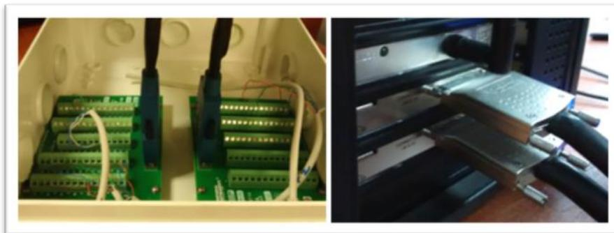
**Figura 1.59. Detalle de la caja de conexiones, borneras y tarjetas de adquisición de datos**
