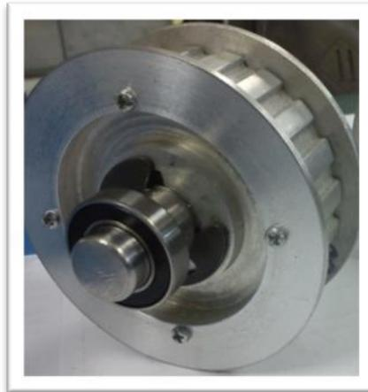
**Figura 1.50. Polea conducida, con eje y rodamientos.**
