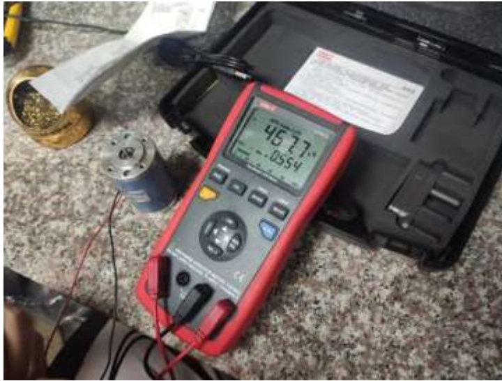
Figura 2.36 Medición de inductancia de armadura. Autor
