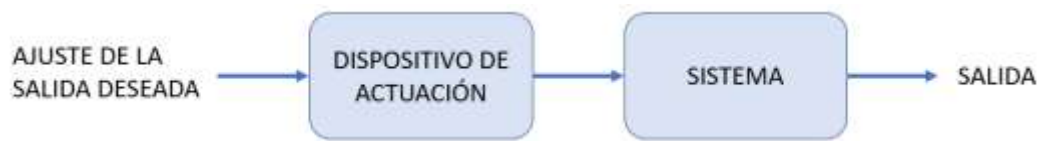
Figura 1.3 Sistema de control en lazo abierto. Autor.
