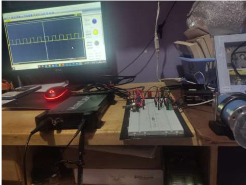
Foto 13 Medición de constante de tiempo mecánica.
