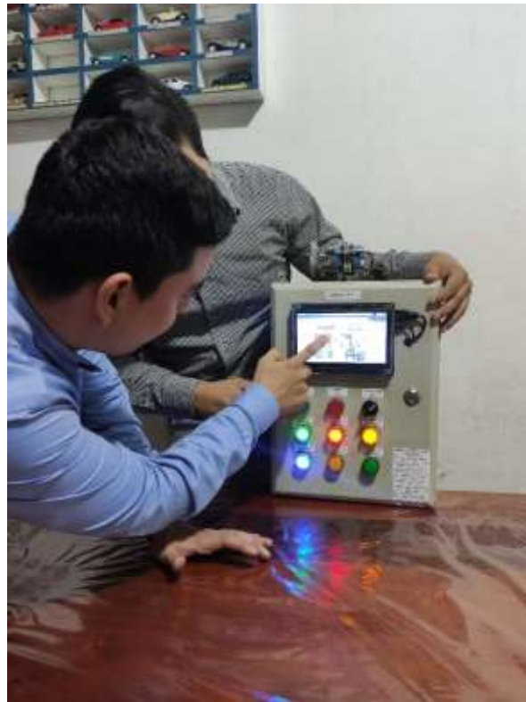
Foto 10 Pruebas de funcionamiento del tablero.
