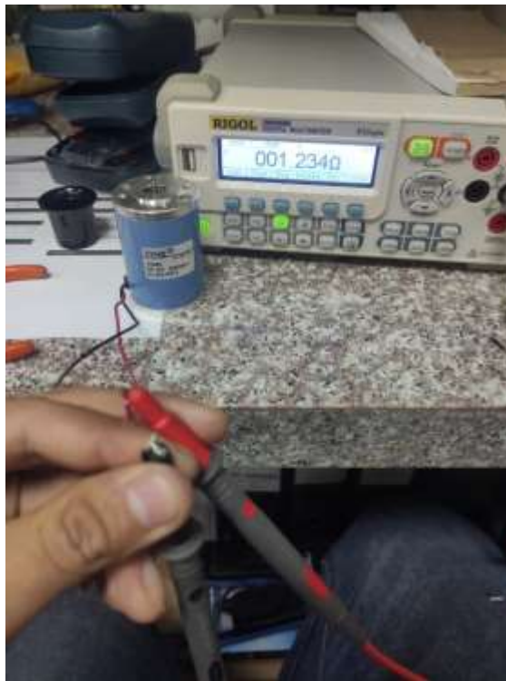
Figura 2.35 Medición de resistencia de armadura. Autor
