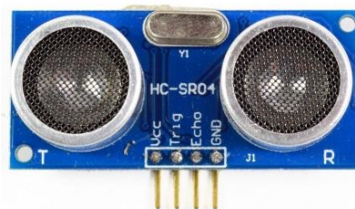
Figura 2.22 Sensor ultrasónico HC-SR04 [67]
