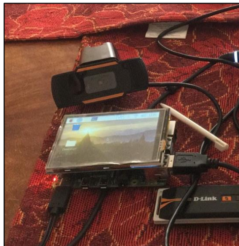
Figura 3.19 Entorno gráfico visible en raspberry pi utilizando una pantalla TFT
