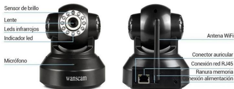
Figura 2.12 Componentes de una cámara IP [42]
