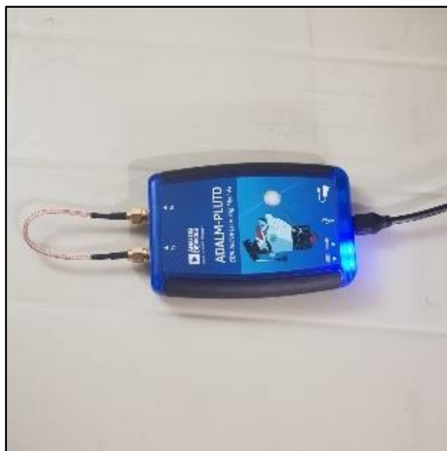
Figura 3.8: Conexión USB del SDR al PC.
