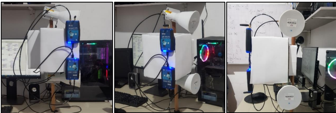
Figura 3.13: Armado del prototipo del sistema de radar.
