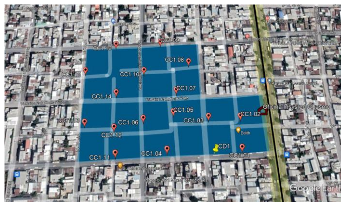
Figura 2.2.2.1 Cajas de distribución y cliente en el polígono 1
