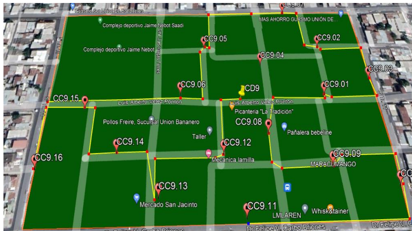
Figura 3.2.2.2 Recorrido completo de fibra de 18 hilos en el polígono 9
