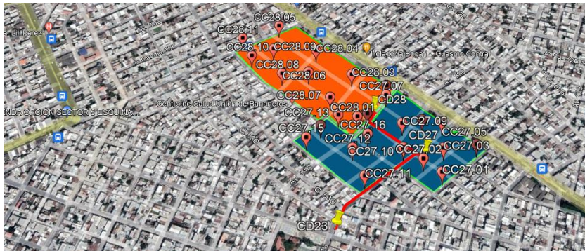
Figura 3.2.1.6 Diagrama de polígonos de fibra 2 buffer verde, hilos completos
