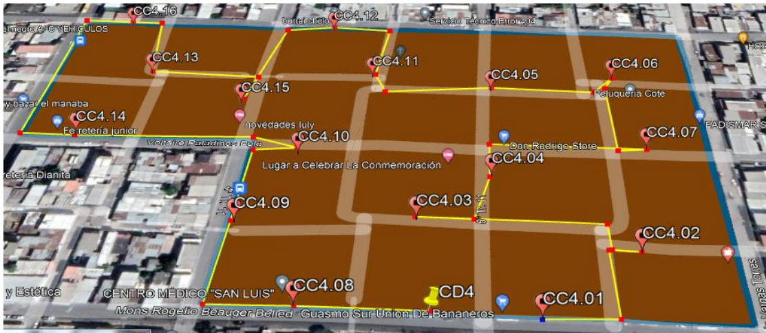
Figura 3.2.2.1 Recorrido completo de fibra de 18 hilos en el polígono 4
