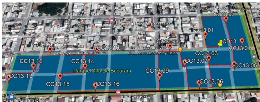
Figura 3.2.2.3 Recorrido completo de fibra de 18 hilos en el polígono 13
