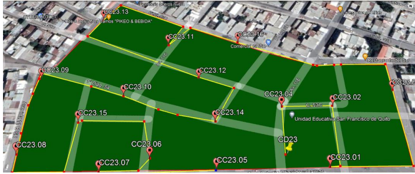
Figura 3.2.2.4 Recorrido completo de fibra de 18 hilos en el polígono 23
