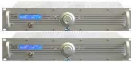
Figura 3. 22 Equipos STL marca Link modelo EXC-RTX18B Fuente: (Link Grupo Adtel, 2018)
