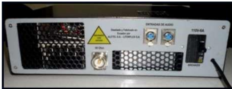
Figura 3. 10 Transmisor Programable M&J MA-FM-100 vista posterior Fuente: Aletel Electrónica S.A.
