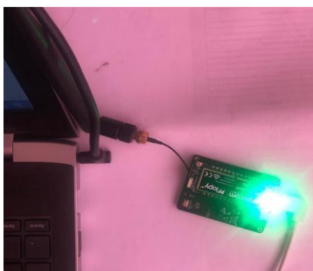
Figura 2.42. Transmisión de datos: Led Verde encendido
