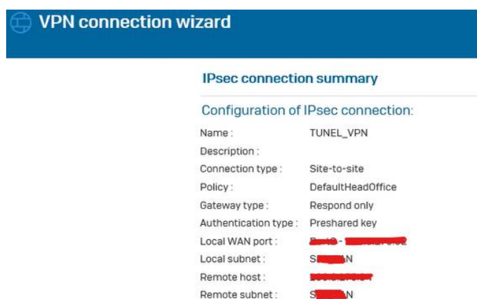
Figura 2.22: Resumen de configuraciones VPN IPsec
