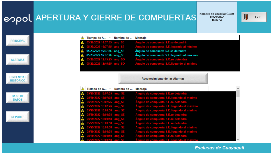
Figura 2.21 Pantalla de Alarmas HMI
