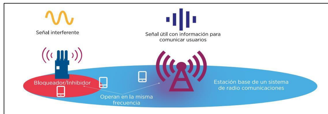
Figura 2.4 Funcionamiento de Inhibidor de Frecuencia [6]
